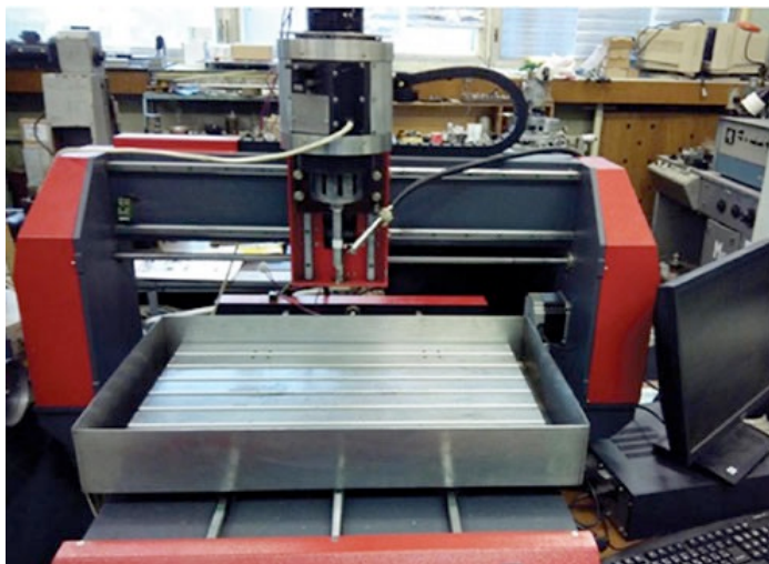
Рисунок 2. – Многокоординатный станок с ЧПУ для комбинированной алмазно-ультразвуковой обработки композиционных изделий [4]
